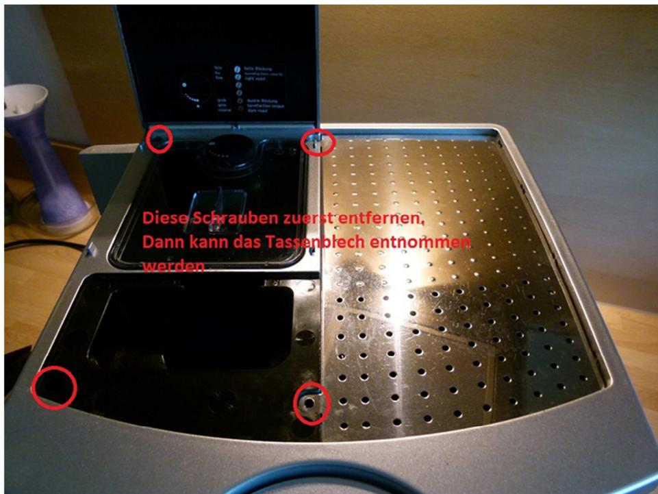
Diese Schrauben zuerst entfernen,
