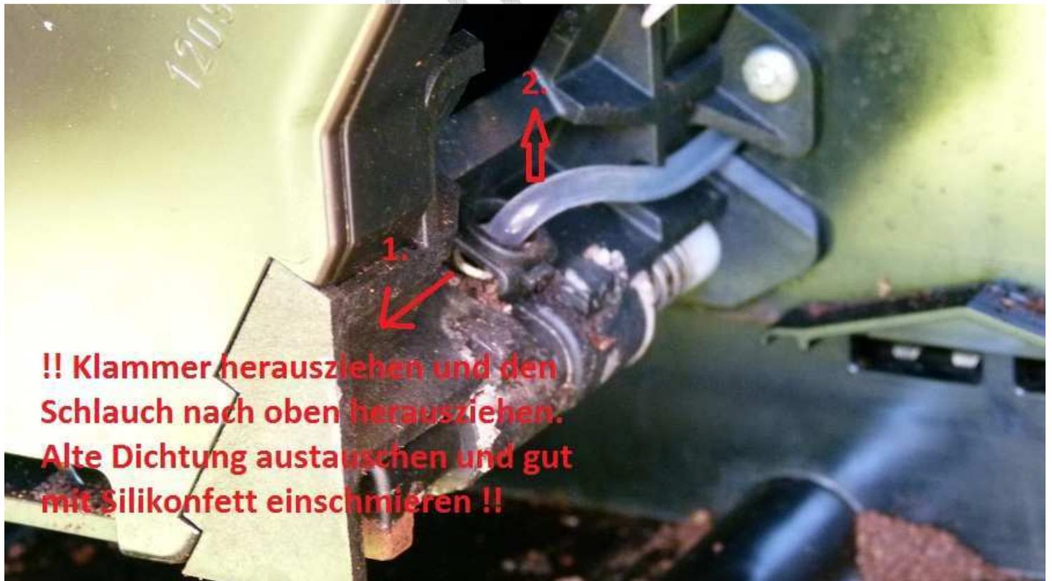
**Der Schlauchanschluss muss gelöst werden**
