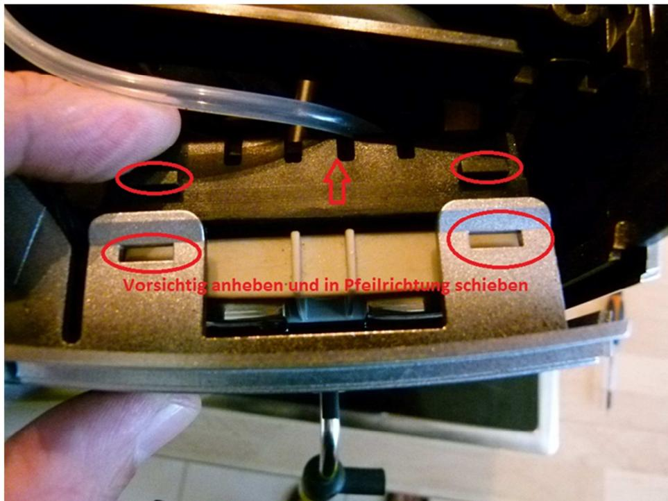
Um die Tür aufklappen zu können, muss der Schlauch vorsichtig gelöst werden. Hierzu die Halterung leicht mit einem Schraubenzieher nach oben biegen und dann nach rechts abziehen
